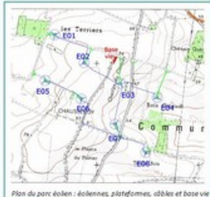
Plan du parc éolien : éoliennes, plateformes, câbles et base vie
